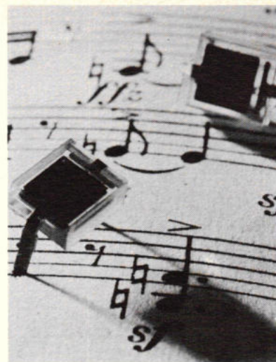
Optische elektronica „met muziek“: de infrarood-fotodiode BPW 34 van Siemens maakt draadloze ontvangst per hoofdtelefoon van radio- en TV-programma of muziek van een platenspeler mogelijk. De werkzame oppervlakte bedraagt 9 mm 2 .
